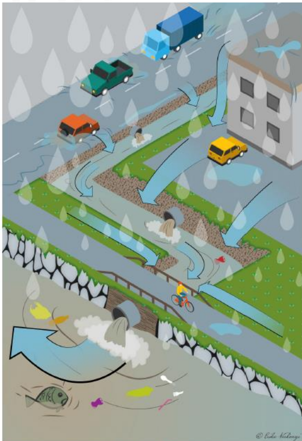
Esimerkki perinteisestä hulevesien hallinnasta
